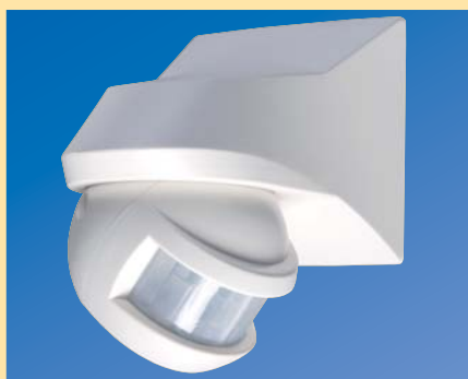
Hlava čidla je otočná v rozsahu 180° a sklopná v rozsahu 0–40°, což umožňuje bezproblémovou montáž s optimálním nastavením rozsahu snímání.
